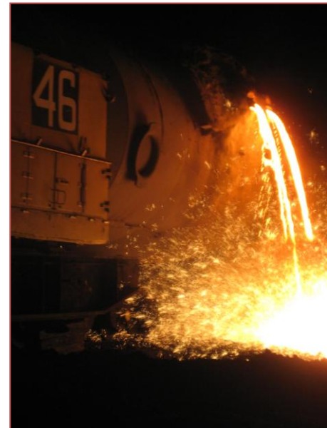
รูปแสดง การเทน้ำเหล็กออกจาก Torpedo
