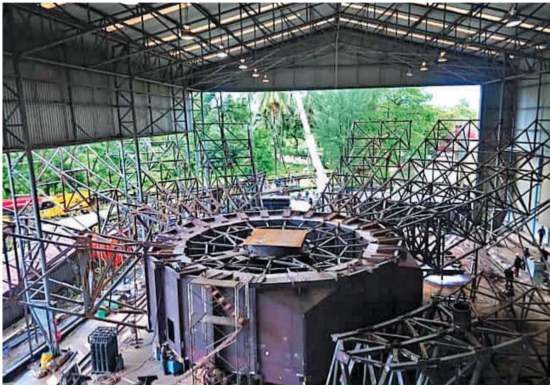
การผลิและประกอบโครงสร้างงานดาวเทียม ของบริษัท เวสท์โคสต์เอ็นจิเนียริ่ง จำกัด หรือ WCE มีขนาดเส้นผ่านศูนย์กลาง 40 เมตร โดยใช้ฐานการผลิต ณ โรงงานอำเภอบางสะพาน จังหวัดประจวบคีรีขันธ์ ก่อนดำเนินการเคลื่อนย้ายติดตั้งไปยังพื้นที่ศูนย์ศึกษาการพัฒนาห้วยฮ่องไคร้อำเภอดอยสะเก็ด จังหวัดเชียงใหม่ รวมมูลค่างานก่อสร้าง 141,600,000 บาท
